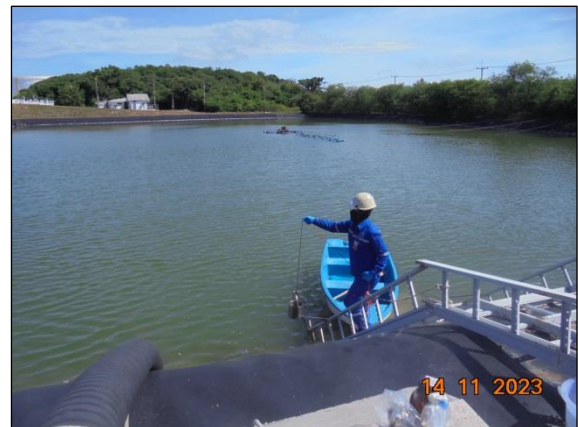
รูปที่ 3.2-2 การเก็บตัวอย่างคุณภาพน้ำทิ้ง บ่อพักน้ำสำหรับดับเพลิง (บ่อพักน้ำทิ้งจากปอดตกตะกอน)
